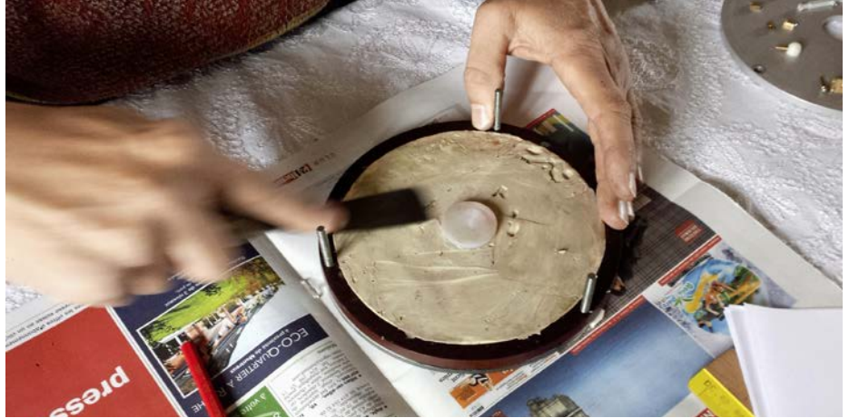
Begonnen wird bei der Formherstellung mit einer temporären Schicht Knetmasse (Plastilin).
