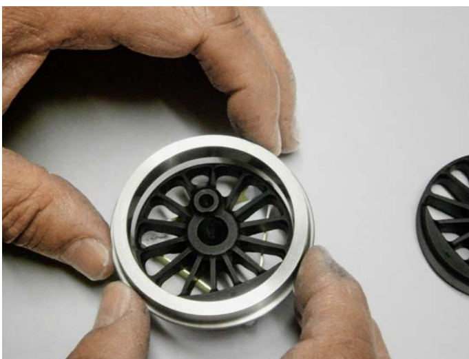
Nach dem Aufbringen des Klebstoffes wird der Stahlreifen aufgeschoben.
