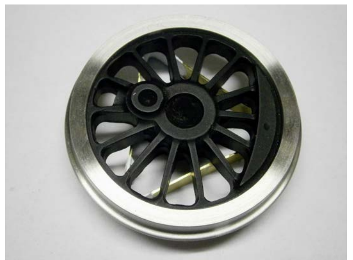
Drei-Punkt-Auflage sorgt beim Aushärten für eine exakte Position.
