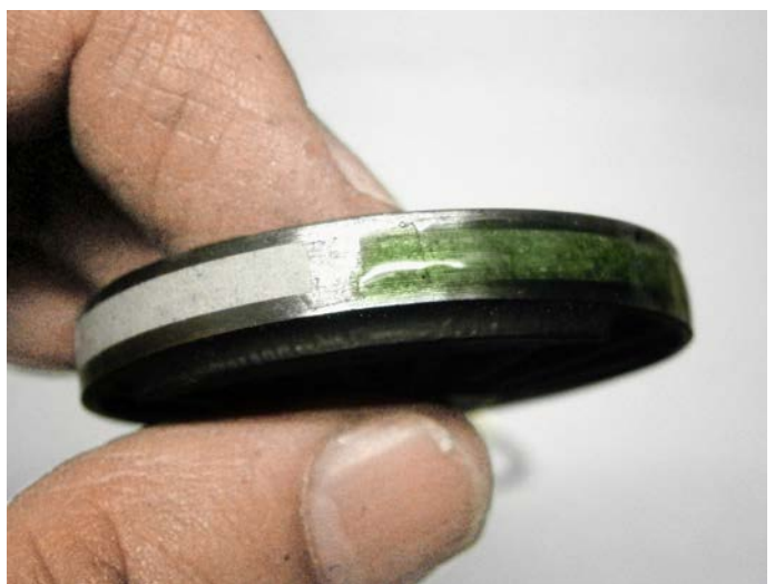
Der Kleenexstreifen sorgt für Abstand zum aufzuklebenden Radreifen.
