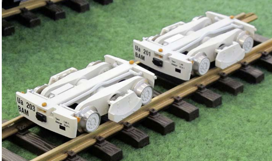
Auch diese Rollböcke der BAM in Spur 11m bestehen unter anderem aus einer Vielzahl von Gussteilen.
