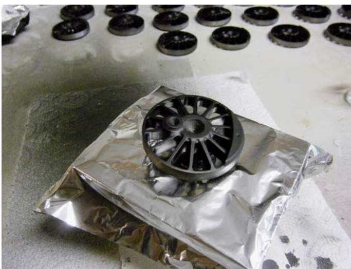
Diese Radkerne wurden bereits exakt abgedreht und werden nun lackiert.
