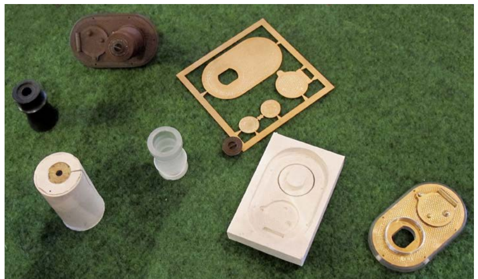
Komplexere Projekte bestehen aus mehreren Gussteilen, welche vom Modellbauer noch zu montieren sind.
