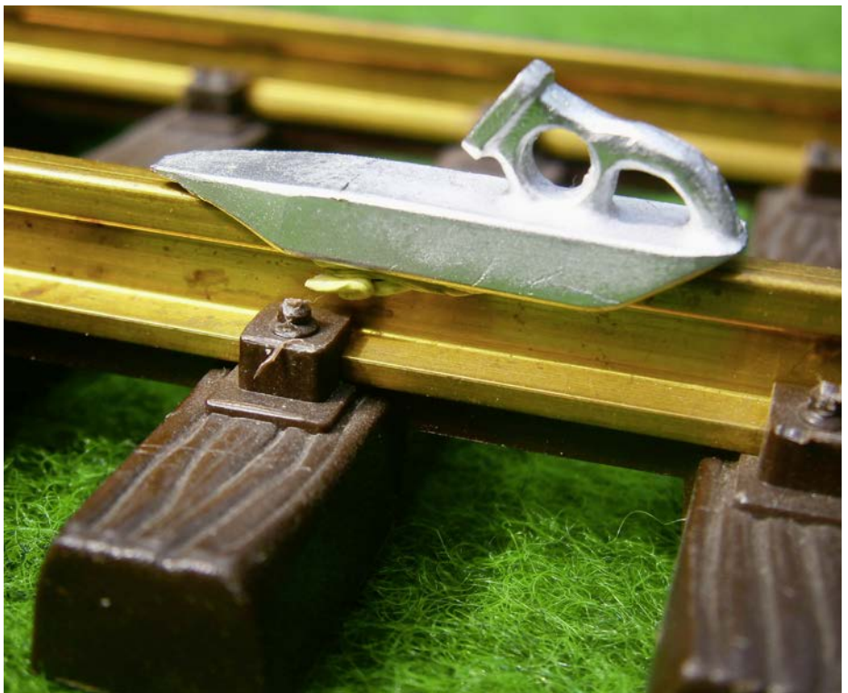
Je sorgfältiger die Form gemacht wurde, desto weniger Nacharbeit benötigt das Gussteil.
