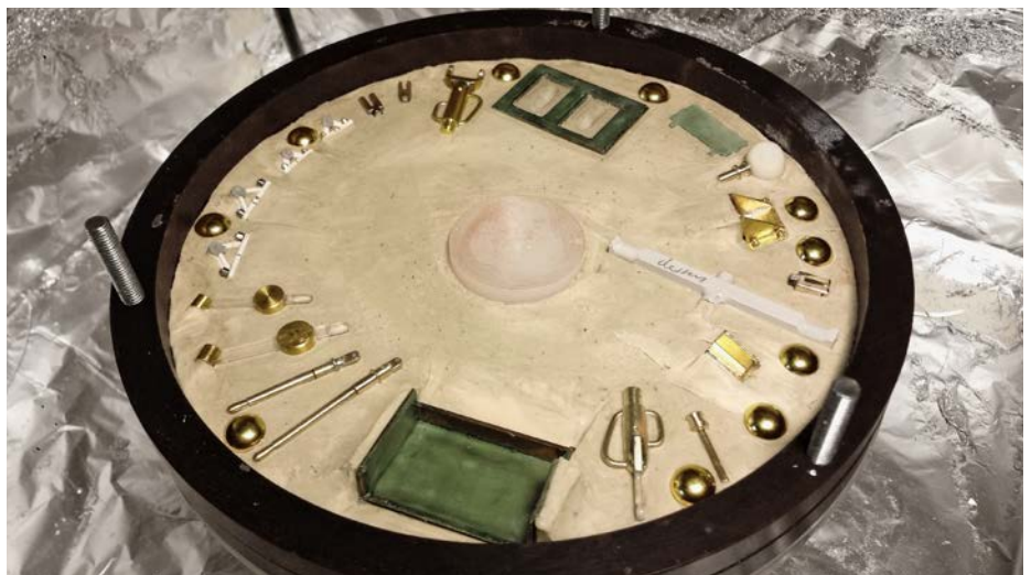
In die Knetmasse werden die Urmodelle und Positionierkörper zur Hälfte eingedrückt.
