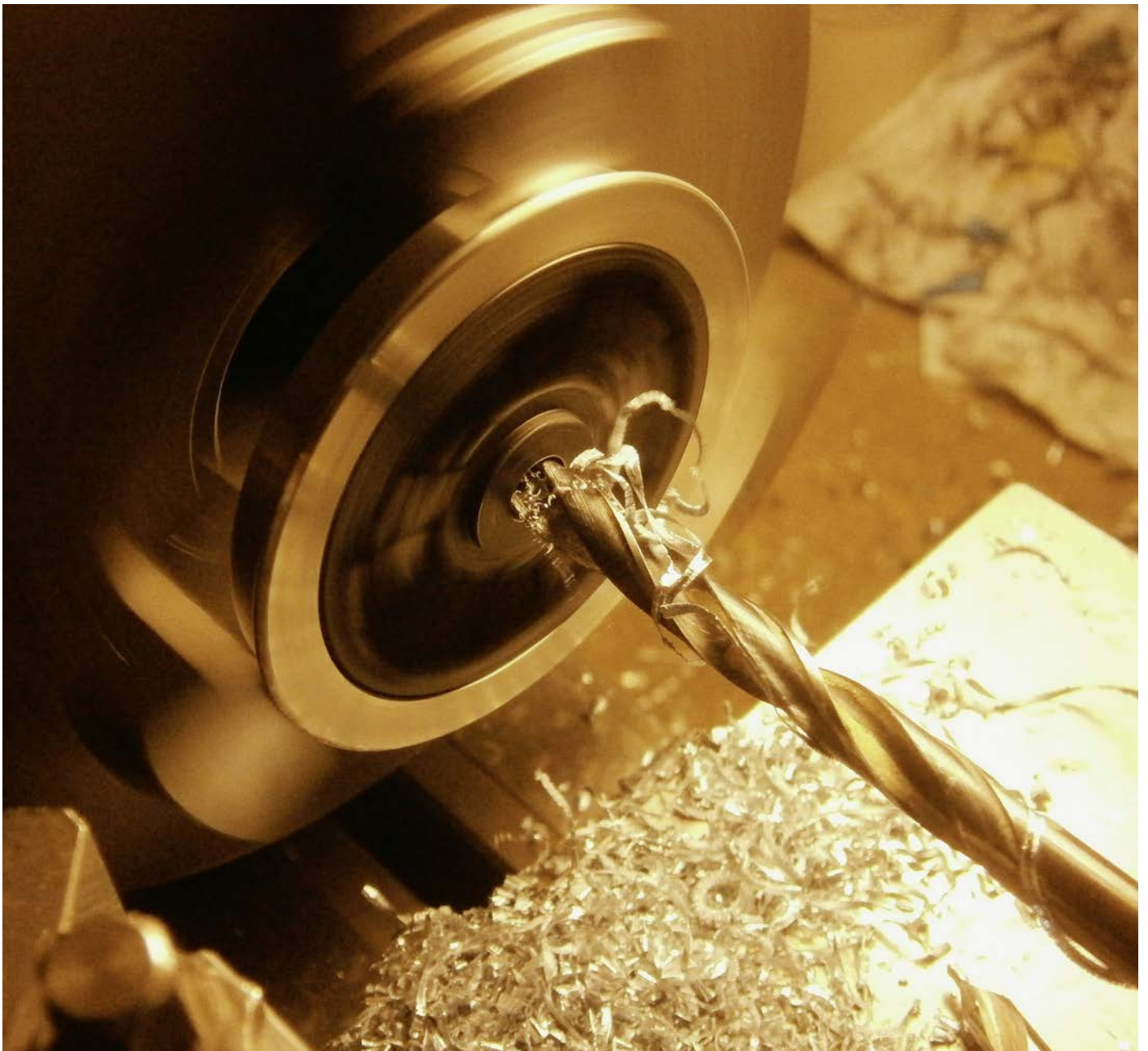
Nach dem Aushärten erhält das Rad auf der Drehbank die exakte Bohrung. Der Radkern wurde aus Kayem gegossen, was an den schönen Spänen erkennbar ist.
