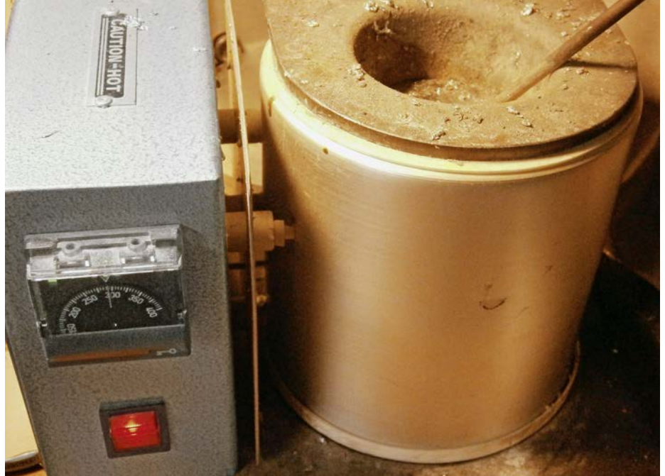
Der elektrisch beheizte und thermostatisch geregelte Schmelztiegel erhitzt das Weissmetall auf 290° C.
